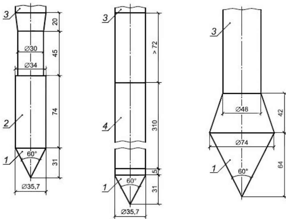
а) Механический зонд (тип I) для статического зондирования
